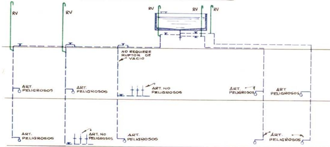
RV PROLONGADOS HASTA EL AIRE LIBRE O CONECTADOS AL TANQUE POR LA CUBIERTA. RV DE Ø IGUAL AL RV MAYOR CONECTADO
