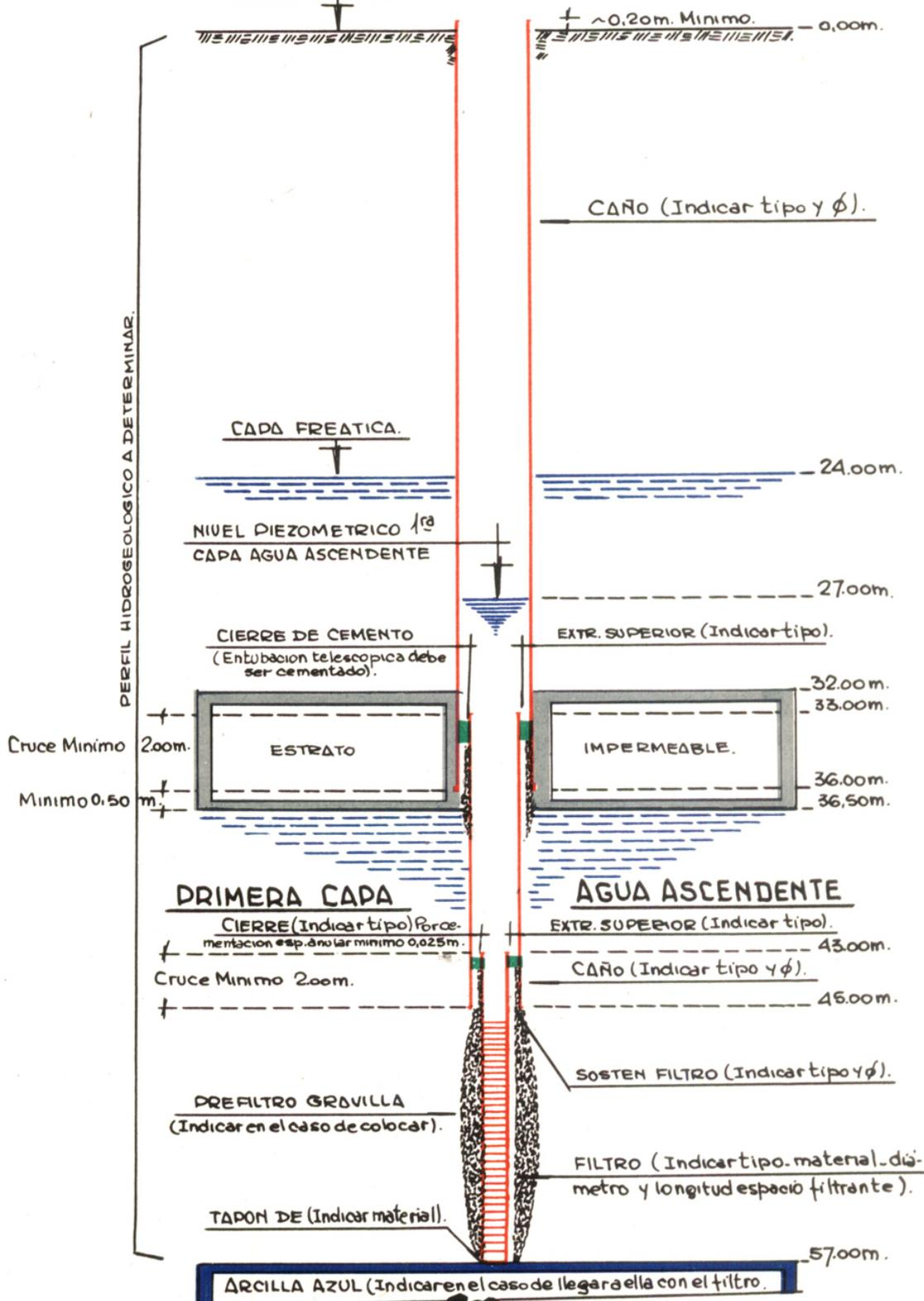
NOTA: Para descenso del filtro se descendera la 2da cañeria de (Indicar tipo y φ) hasta la profundidad proyectada, levantando luego esta a las cotas indicadas.
