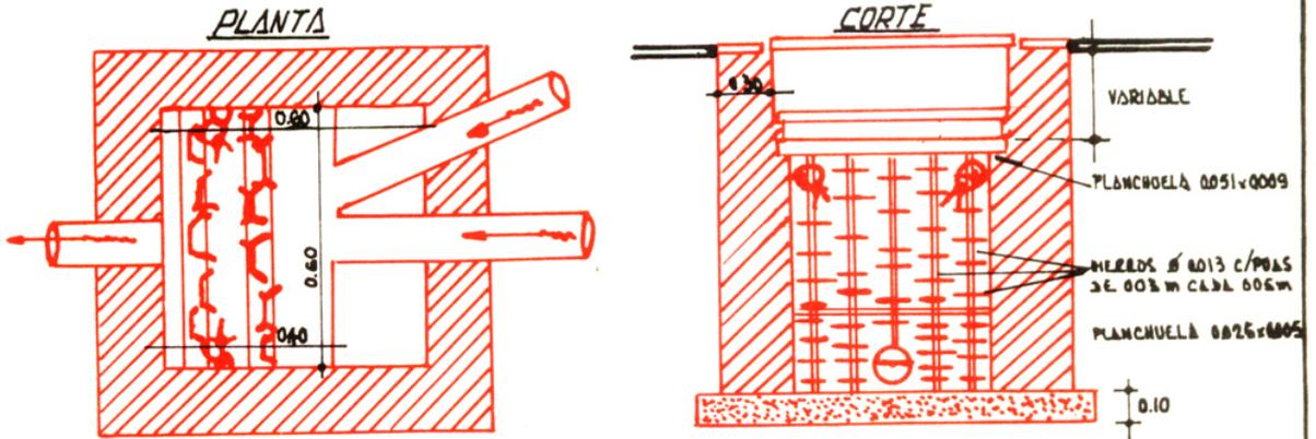
SE INSTALA EN LA 1ª C.I. EXISTENTE A LA SALIDA DE LA CONEXION DE CLOACA
