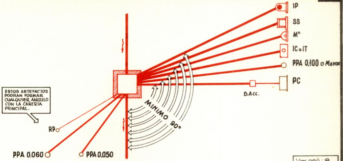
**EMPALME DE CANERIAS DE HORMIGON O MATERIAL VITREO A CANERIAS DE HIERRO FUNDIDO**
