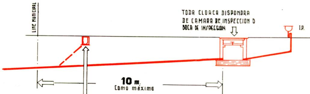
TOCA CLOACA DISPONDRÁ DE CAMARA DE INSPECCION O BOCA DE INSPECCION
