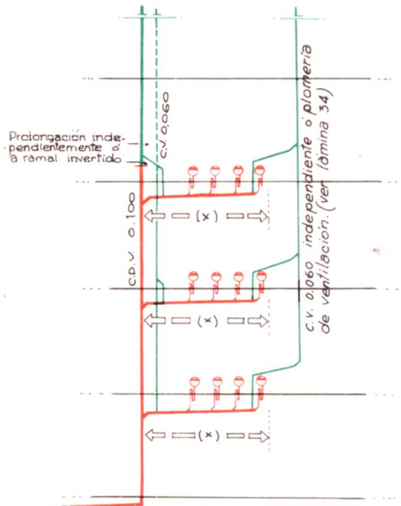
(\*) Ramificación de desagüe que exceda de 10m. de desarrollo y/o excede del n° máximo de artefactos tolerados en ramificación no ventilada. (ver lamina 27)
