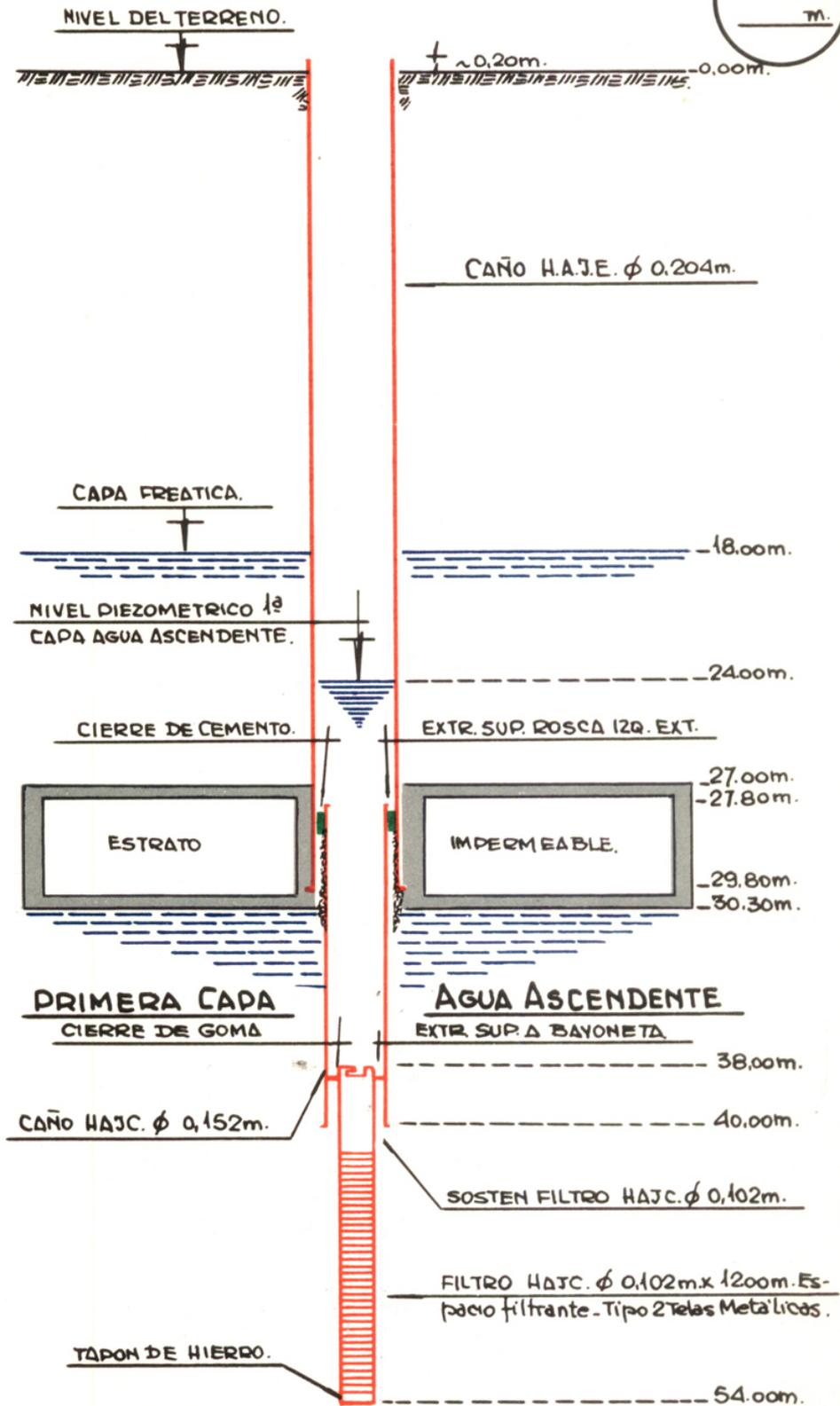
**NOTA:** Para descenso del filtro se bajo la cañería de H.A.J.C.  $\phi$  0,152m. hasta la profundidad total, levantando luego esta, quedando a las cotas indicadas.
