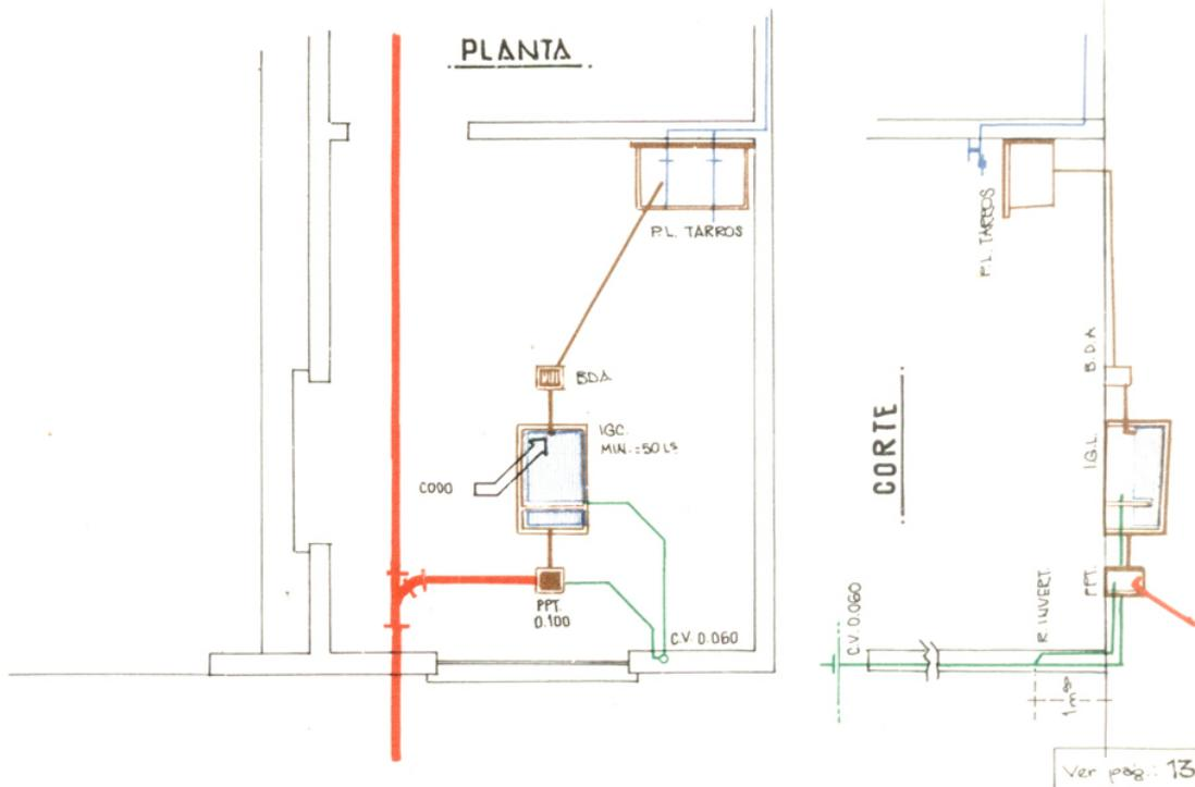
**POZO IMPERMEABLE EN LOCALES DE CALEFACCION, BOMBAS, ETC.**
