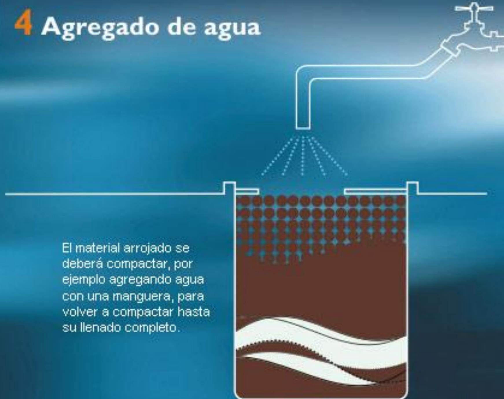
El material arrojado se deberá compactar, por ejemplo agregando agua con una manguera, para volver a compactar hasta su llenado completo.
